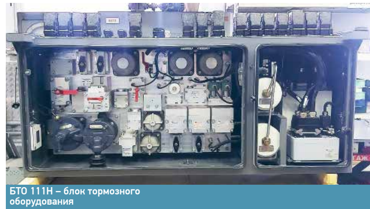
КМ 345Б – кран машиниста, БЭТ 093Б – блок экстренного торможения
