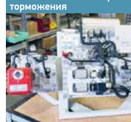
КМ 345Б – кран машиниста, БЭТ 093Б – блок экстренного торможения
