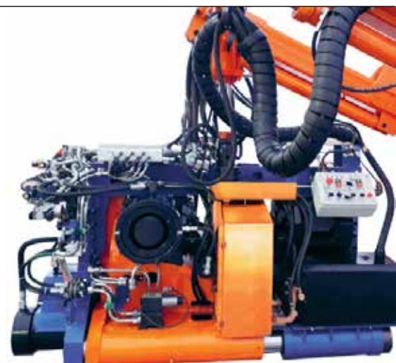
Подвесная рельсоварочная машина типа МСР-120.02 У1
