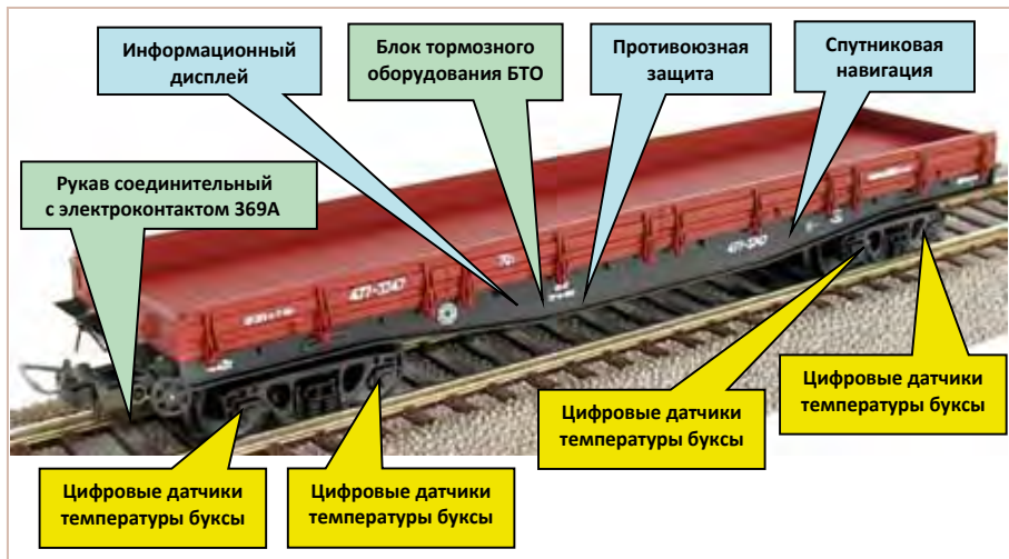
Рис. 6. Пример оснащения грузовой платформы оборудованием системы ИСКРА.200
