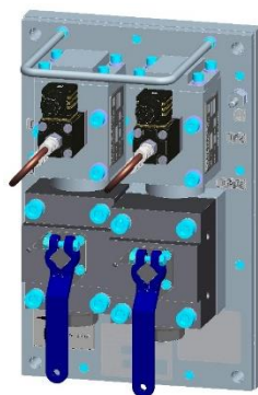
Рис.10 Блок пневматического оборудования 419
