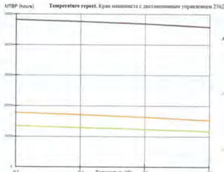
Рис. 4. Температурные кривые (интенсивность отказов/средняя наработка на отказ)
