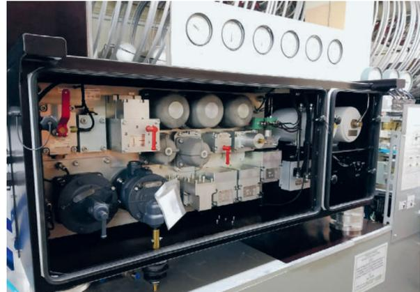
Блок тормозного оборудования 111 для скоростной вагон-платформы модели 13-6704 на 160 км/ч
