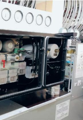
Блок тормозного оборудования 111 для скоростной вагон-платформы модели 13-6704 на 160 км/ч
