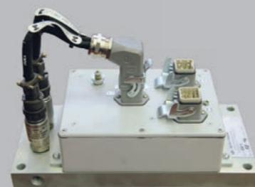
Блок управления петлей безопасности 077MB предназначен для управления автоматическим электропневматическим тормозом при снижении давления в тормозной магистрали в основном режиме управления.
