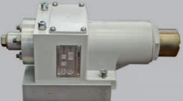
Авторежим пневматический 141MB предназначен для автоматического регулирования величины давления сжатого воздуха в тормозном цилиндре в зависимости от населенности вагона.
